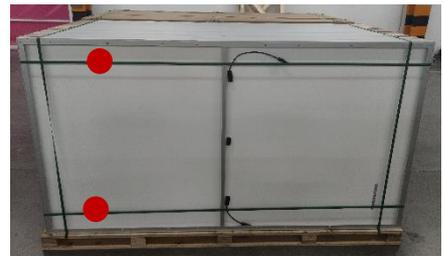
将组件推向倚靠物（如墙壁、支架、另一托组件等），并拆除剩余打包带。
