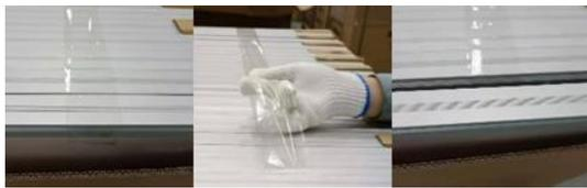
两名工人一起操作，一次撕开一件组件两端的固定胶带，并须将胶带卷起来，如上图撕开后照片。
