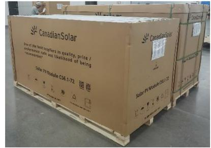
拆开包装箱外部所有打包带。
