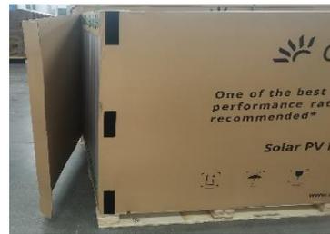
拆开围箱，并拆开四条水平打包带（红色标记），黄色标记位置打包带各拆除一条。
