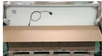
两名工人一起将组件从包装箱内取出。重复第五步和第六步，逐个将组件取出。
