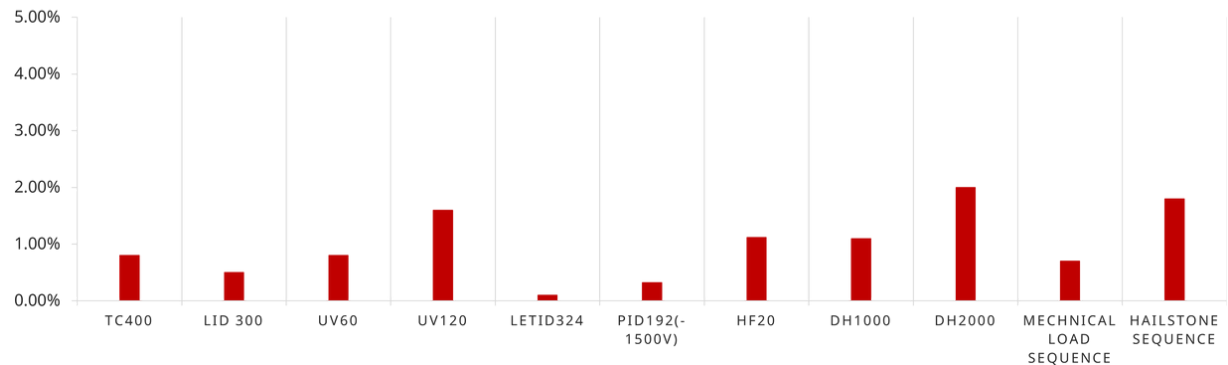
图10. 新一代N型高功率组件测试结果
